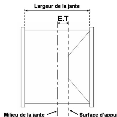
E.T : distance entre le milieu de la jante et la surface d'appui de celle-ci.
